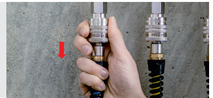
Entkuppeln - Stufe 2: gefahrloses Entkuppeln
