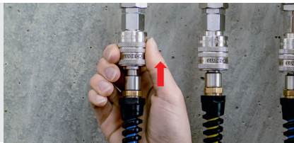
Entkuppeln - Stufe 1: Automatisches Entlüften
